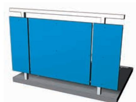
4. sichtbare Befestigung an Pfosten in Sektionen mit Z-Profilen
