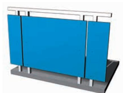
3. sichtbare Befestigung an Pfosten – durchlaufende Platte
