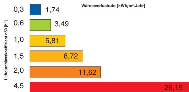
Diagramm 3: Konstruktionen mit einer erhöhten Luftdurchlässigkeit weisen höhere Wärmeverluste auf und somit einen höheren Energiebedarf. Bei herkömmlichen Bauten mit einer konventionellen, natürlichen Lüftung ( $n_{50} = 4,5 \text{ h}^{-1}$ ) sind die Wärmeverluste verursacht durch die hohe Luftdurchlässigkeit der Gebäudehülle fast 8 mal höher als bei Passivhäuser mit einem Wert von  $n_{50} = 0,6 \text{ h}^{-1}$ .
