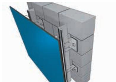
Innerhalb von 10 Minuten müssen die Platten ausgerichtet sein, um sie dann endgültig an die Unterkonstruktion festzudrücken. Nach der Befestigung auf dem doppelseitigen Klebeband können keine Positionsänderungen mehr durchgeführt werden.
