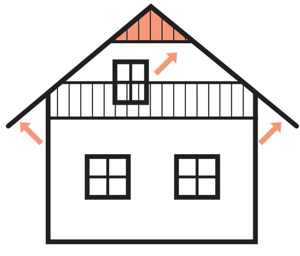
Abb. 16: Dachschalung. Hier versteht man unter geschütztem Außenbereich die Anwendungsbedingungen der Feuchtklasse 2.
