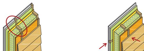
Abb.22: Verbesserung der Luftschalldämmparameter der Außenwand von ursprünglich 42 dB (links) auf 49 dB:
